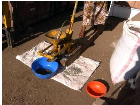
ジャトロファの実の搾油作業(地元住民は搾っ た油をランプ、調理器の燃料や石鹸の原料とし て利用している)
